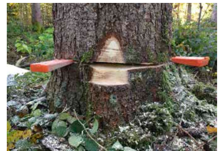
Abb. 3: Erweiterung des Fällschnitts, sogenannter Schnabelschnitt, um den mechanischen Fällkeil einsetzen zu können.
