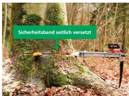
Abb. 1: Mechanischer Fällkeil im Schnabelschnitt.
