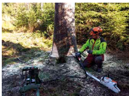
Abb. 2: Fernbedienbarer hydraulischer Fällkeil.
